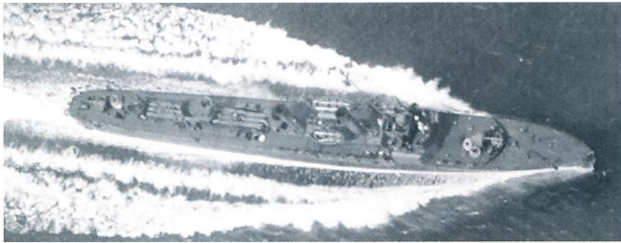
Torpedobåden Dragen (1929) fotograferet fra luften under fuld-kraftsprøve. Bådene fik en topfart på ca. 29 knob og var armeret med 8(Dragen-kl.) og 6(Glenten-kl.) 45cm torpedoudskydnings-apparater, samt 2 75mm(Dragen-kl.) og 2 87mm(Glenten-kl.) kanoner. Besætningen var på 51 mand.
